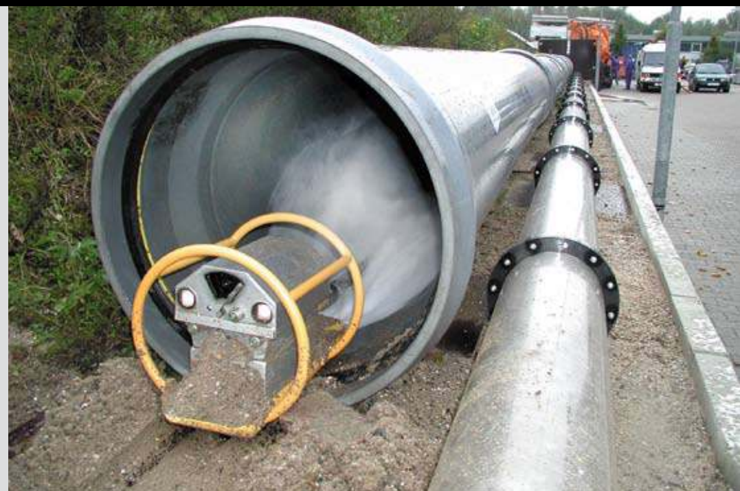
Auch nach über 300 Hochdruckreinigungen weist dieses PVC-Rohr keine nennenswerten Materialveränderungen auf.
