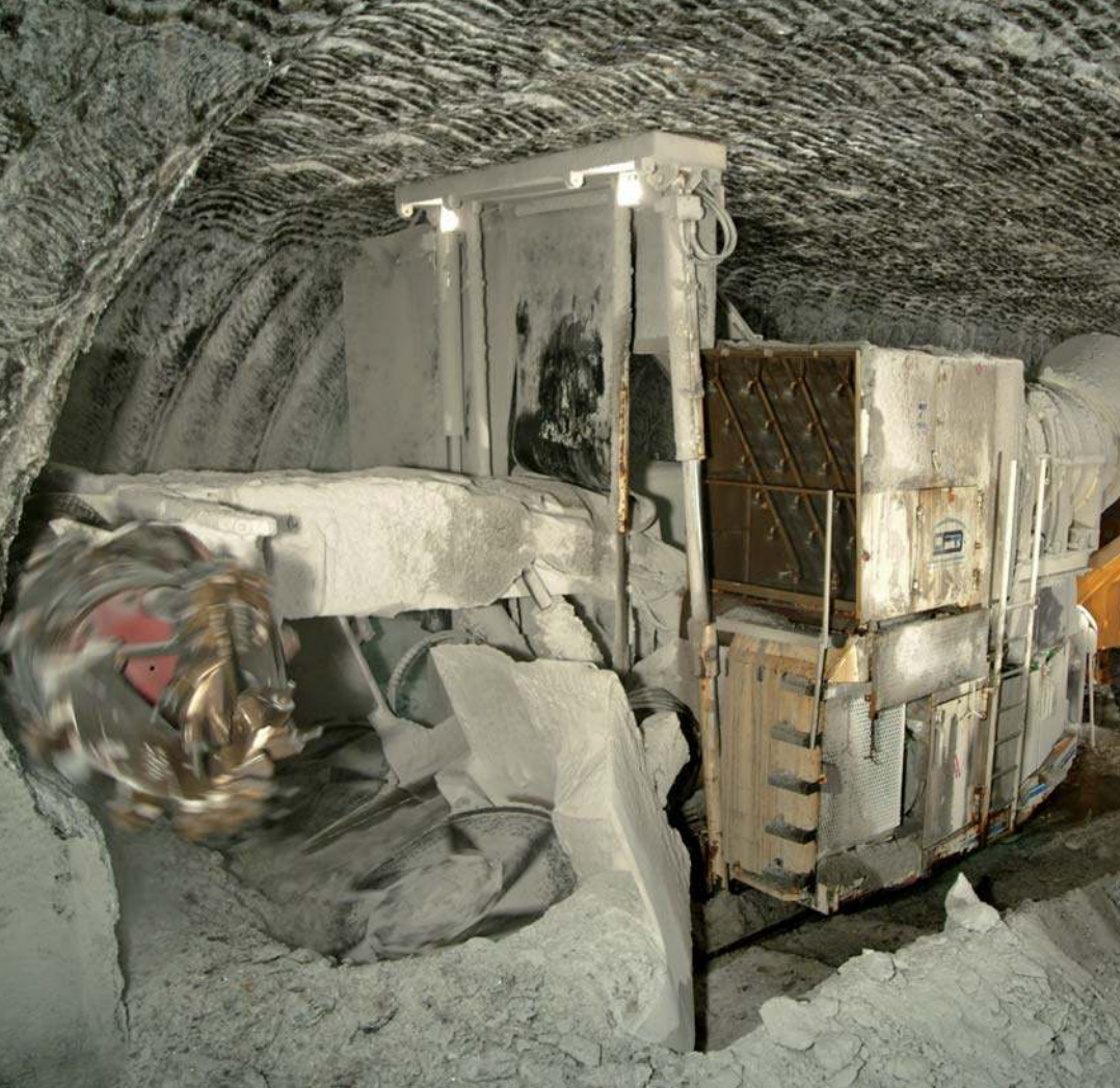
Salzabbau mit schwerem Gerät: Der Continuous Miner im Einsatz.
