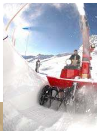
Schneefräse zum Einschnüren der aufgeblasenen PVC-Ballone.
