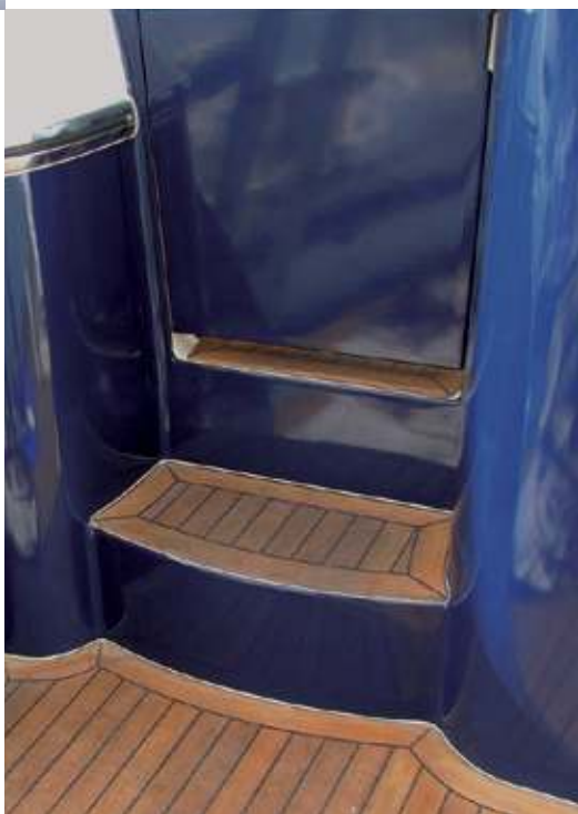
Auch die Oberdecks von Yachten lassen sich vollflächig mit salzwasserfesten, UV-beständigen PVC-Folien verkleben: vom Treppenaufgang bis zum Ruderstand und Deckaufbauten.
