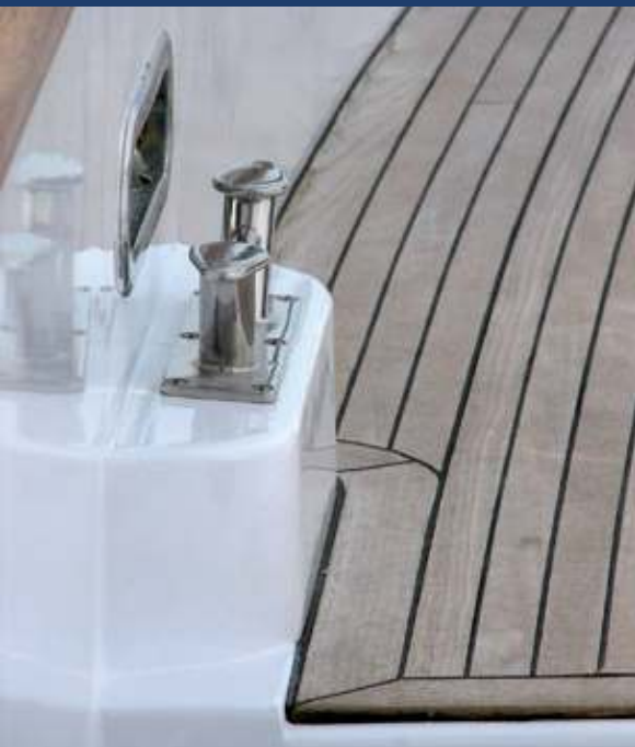
Auch die Oberdecks von Yachten lassen sich vollflächig mit salzwasserfesten, UV-beständigen PVC-Folien verkleben: vom Treppenaufgang bis zum Ruderstand und Deckaufbauten.
