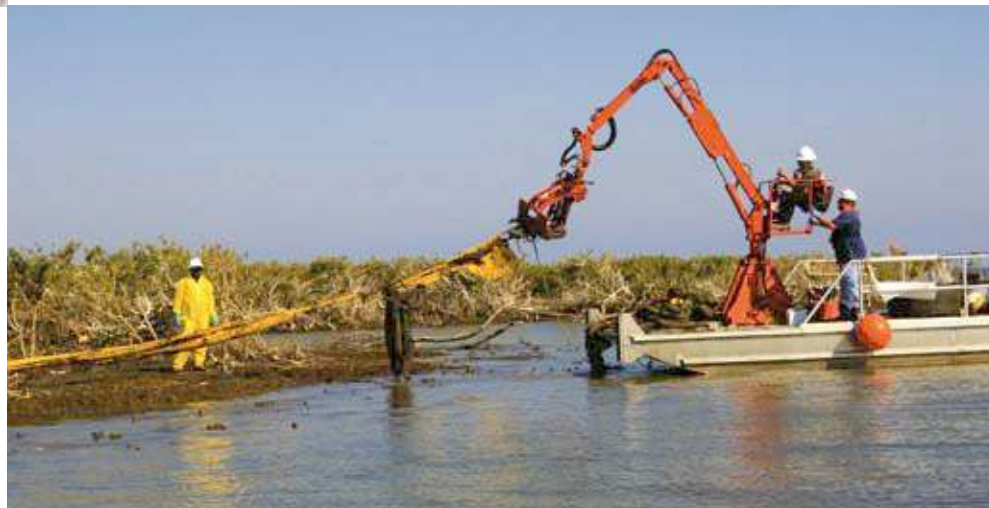
Bilder, die um die Welt gingen: Öl-Barrieren, viele davon aus PVC-beschichtetem Textilgewebe, hielten das austretende Öl im Golf von Mexiko so gut wie möglich von den Küsten fern.
