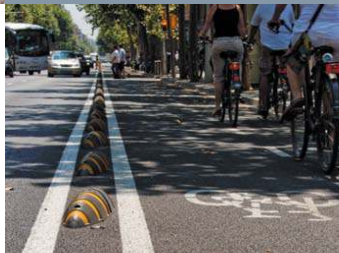
Hergestellt aus PVC-Ummantelungen alter Elektrokabel: Der praktische Spurentrenner „Zebra“ des spanischen Unternehmens Zicla hält Auto- und Radfahrer immer in der richtigen Spur.
