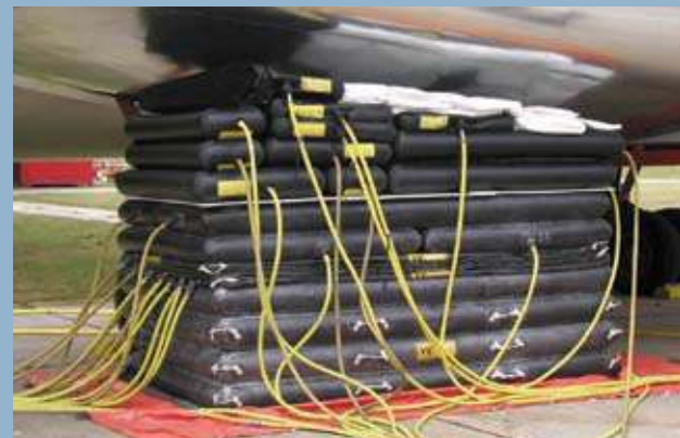
Jede Kontaktkammer des Flugzeughebekissens wird separat mit Luft befüllt, um eine optimale Anpassung an die Ansatzflächen des Flugzeugs zu ermöglichen.
