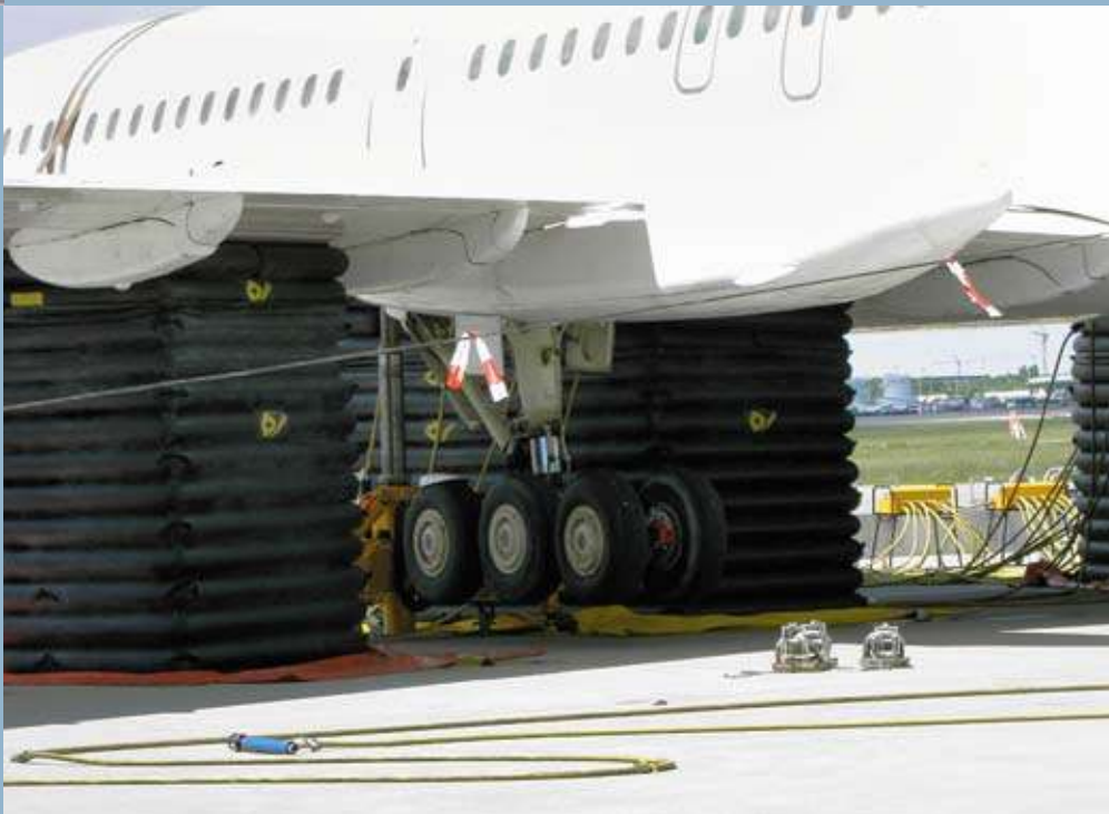
Jede Kontaktkammer des Flugzeughebekissens wird separat mit Luft befüllt, um eine optimale Anpassung an die Ansatzflächen des Flugzeugs zu ermöglichen.
