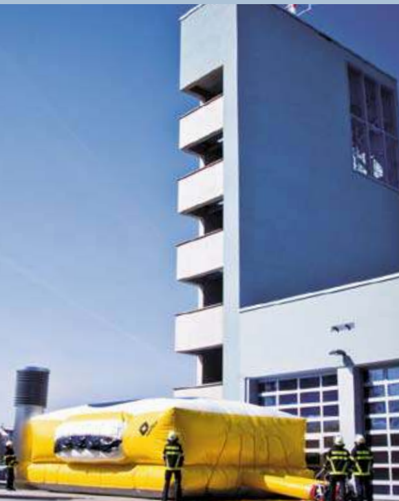
Dieses Sprungkissen aus hochreissfestem PVC-beschichtetem Gewebe kann Menschen, die aus bis zu 60 Metern in die Tiefe springen, bergen.
