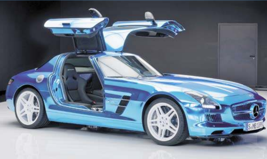
Atemberaubendes Design: Den spiegelnden Chromeffekt erzielten die Spezialisten von INTAX, indem sie drei exakt aufeinander abgestimmte PVC-Folien auf den Sportwagen brachten.
