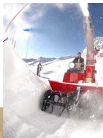
Schneefräse zum Einschnneiden der aufgeblasenen PVC-Ballone.
