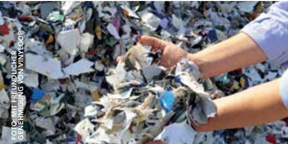
Mit PVC beschichtete Gewebe-Abfälle von Serge Ferrari, die in der VinylLoop®-Anlage in Ferrara, Italien recycelt werden
