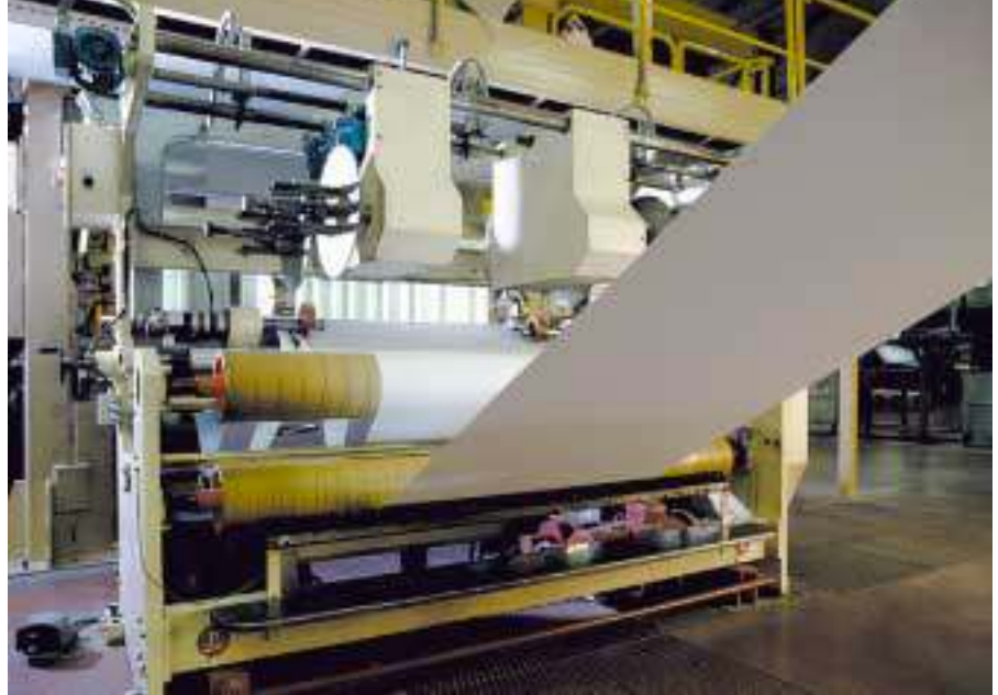
Kalandrierwerk zur Herstellung von PVC-Folie
